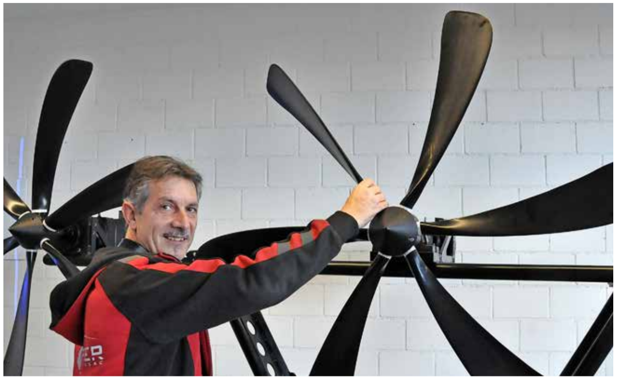
Erfinder Hans Wepfer, Namensgeber von Windrad Hans in Beringen, mit einem 1:11-Modell der neuen Rotoren. Mit Aviatikern der Zürcher Hochschule für Angewandte Wissenschaften optimierte er Flügelform und -stellung im Windkanal. Bild Mark Gasser
